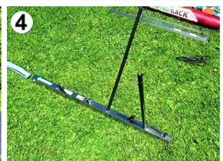
5. Führe die Ausziehwerkzeuge in die Bohrungen des Erdnagels 1 und 4 ein und drehe die Erdnägeln, bis die Ausziehwerkzeuge leicht schräg in Längsrichtung zum Anker stehen. Schläge die Erdnägeln 1 und 4 **vorsichtig** weiter ein, bis die Ausziehwerkzeuge das Ankerrohr **fast berühren**. Die Ausziehwerkzeuge können brechen, wenn die Erdnägeln tiefer eingeschlagen werden. **Schlage die anderen Erdnägeln NICHT tiefer ein.**
